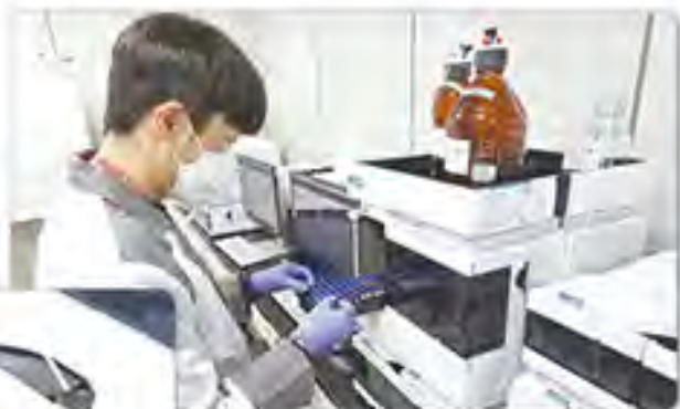
축산물품질평가사가 역체크로마토그래피(HPLC)를 이용하여 꿀의 포도당과 과당을 분석하고 있다.
